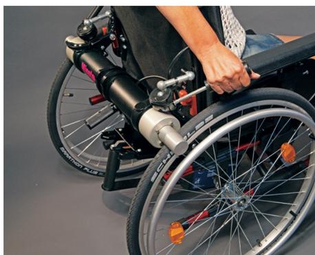
2 moteurs entraînent directement les roues. Il est possible de débrayer et de rouler librement.
