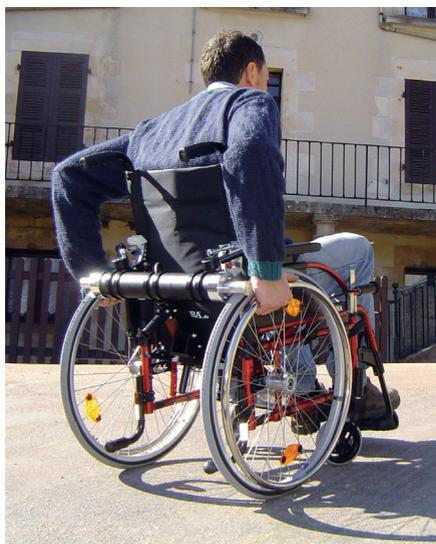
La force électrique du moteur s'additionne à la force motrice des bras. L'utilisateur peut doser l'effort qu'il souhaite fournir. Il règle la puissance par un accélérateur situé près de la main. Il dirige avec les mains courantes ou le manche de conduite qui agit sur une des roues avant. Les deux roues restent possibles pour passer les obstacles plus facilement. La puissance des moteurs est 4 fois celle de bras normaux.
